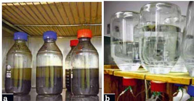
**Foto A** Campioni in camera termostata (a) e metodo di misura del biogas prodotto (b)
